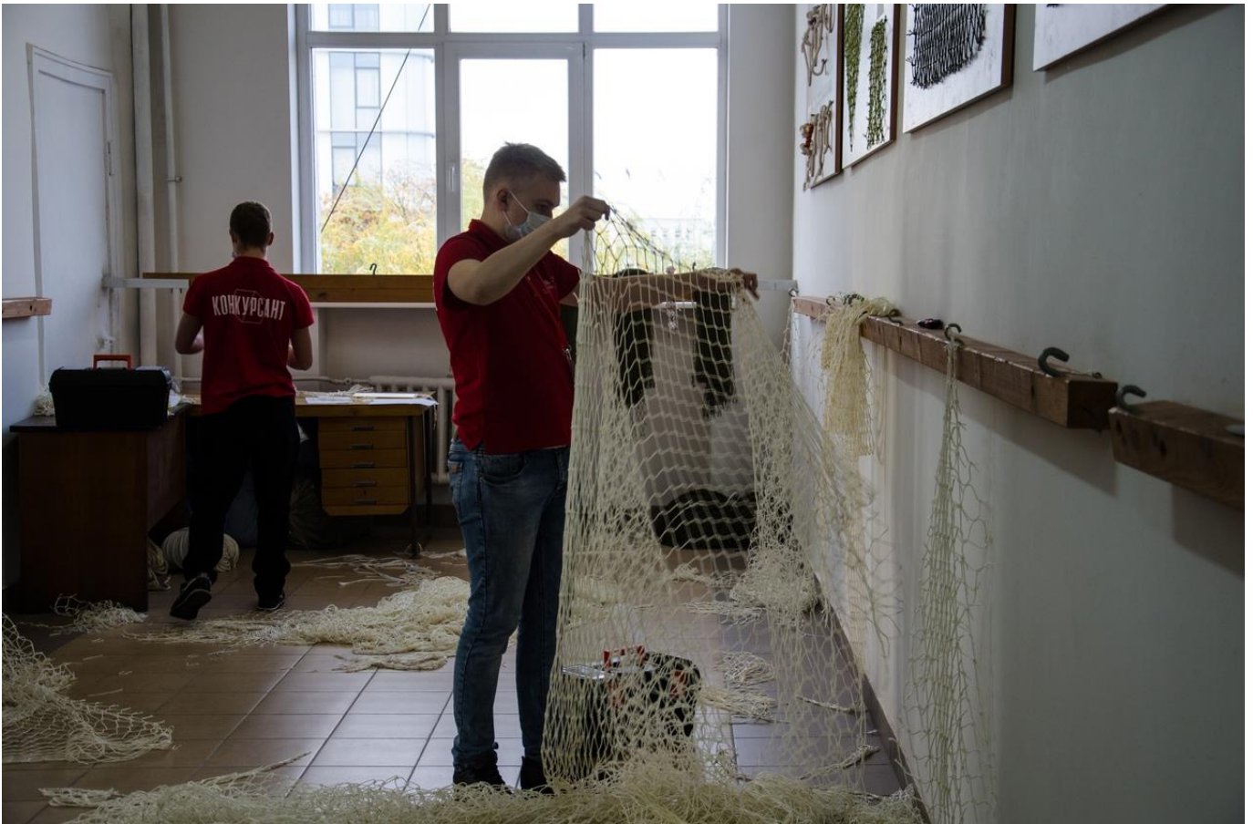
Рисунок 3 - Выполнение конкурсантом модуля С Поиск и ремонт порывов/обрывов
